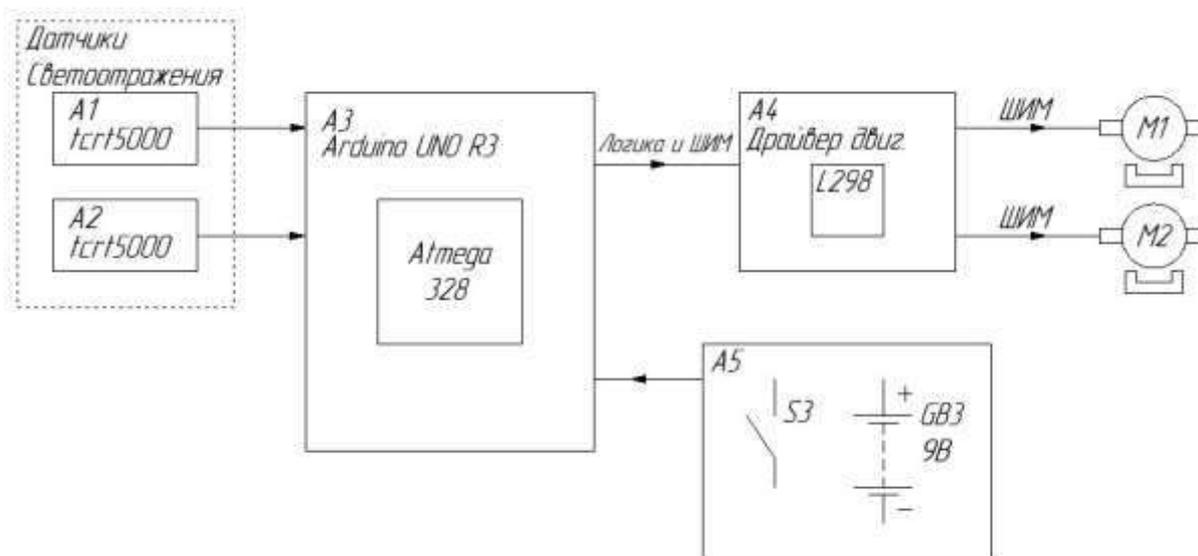
**Рисунок 1. Пример выполнения схемы электрической структурной Э1.**
