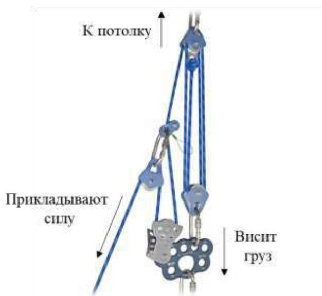
Какой выигрыш в силе даёт такая конструкция, если не учитывать трение и массу конструкции?
