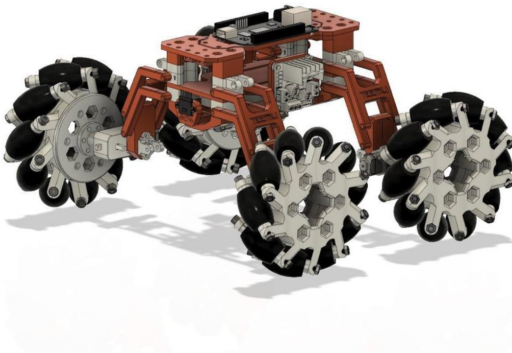
Рисунок 1 – Пример робота на всенаправленных колесах типа mecanum
