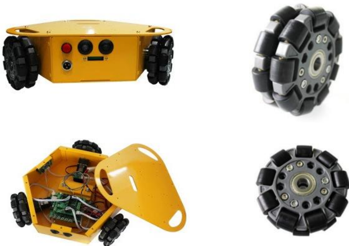
Рисунок 1 – Пример робота и всенаправленного колеса типа omni wheel
