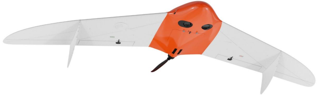
Рисунок 5 – Геоскан 201 выполнен по аэродинамической схеме «летающее крыло».
