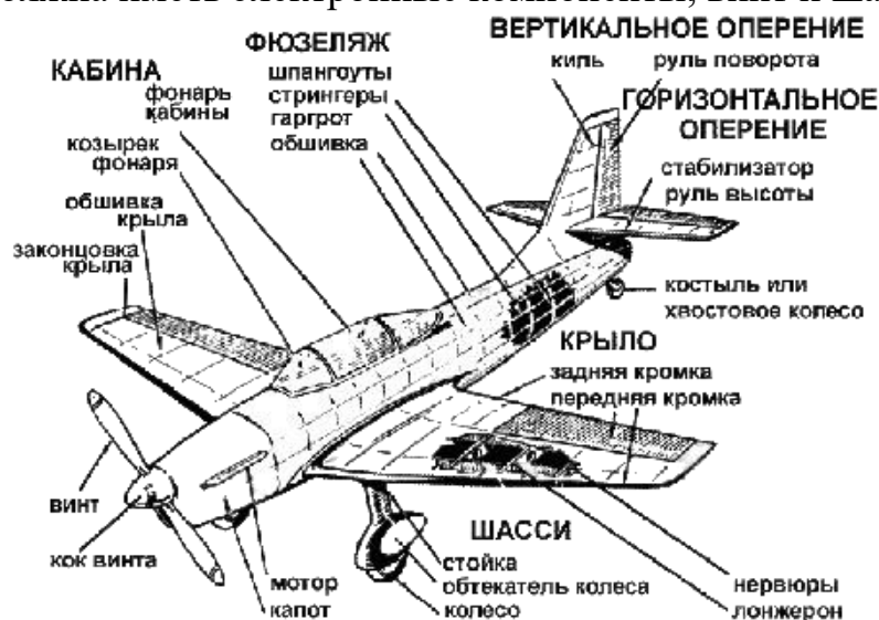
Рисунок 2 – Наименование частей летательного аппарата
